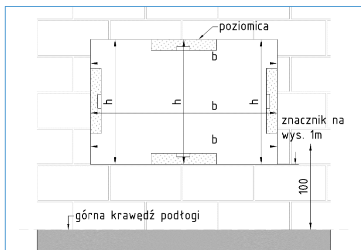
Rys. 2 Sposób pomiaru otworu okiennego
