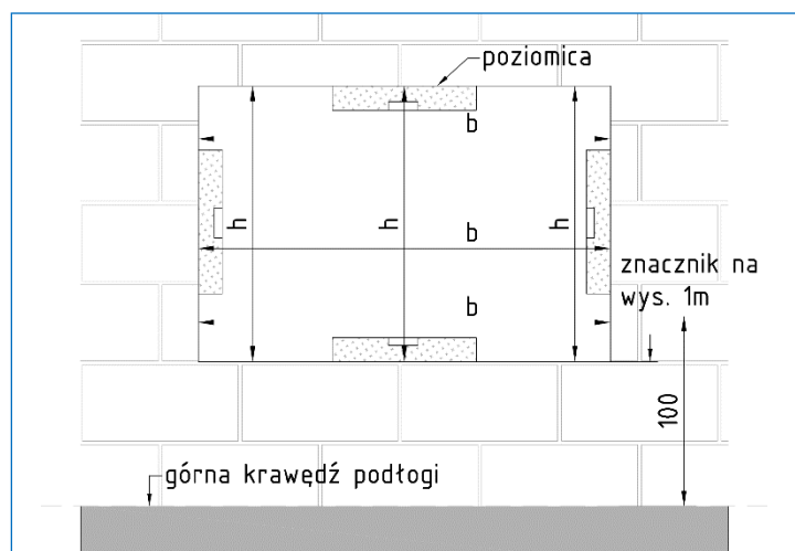
Obr. 2 Způsob měření okenního otvoru
